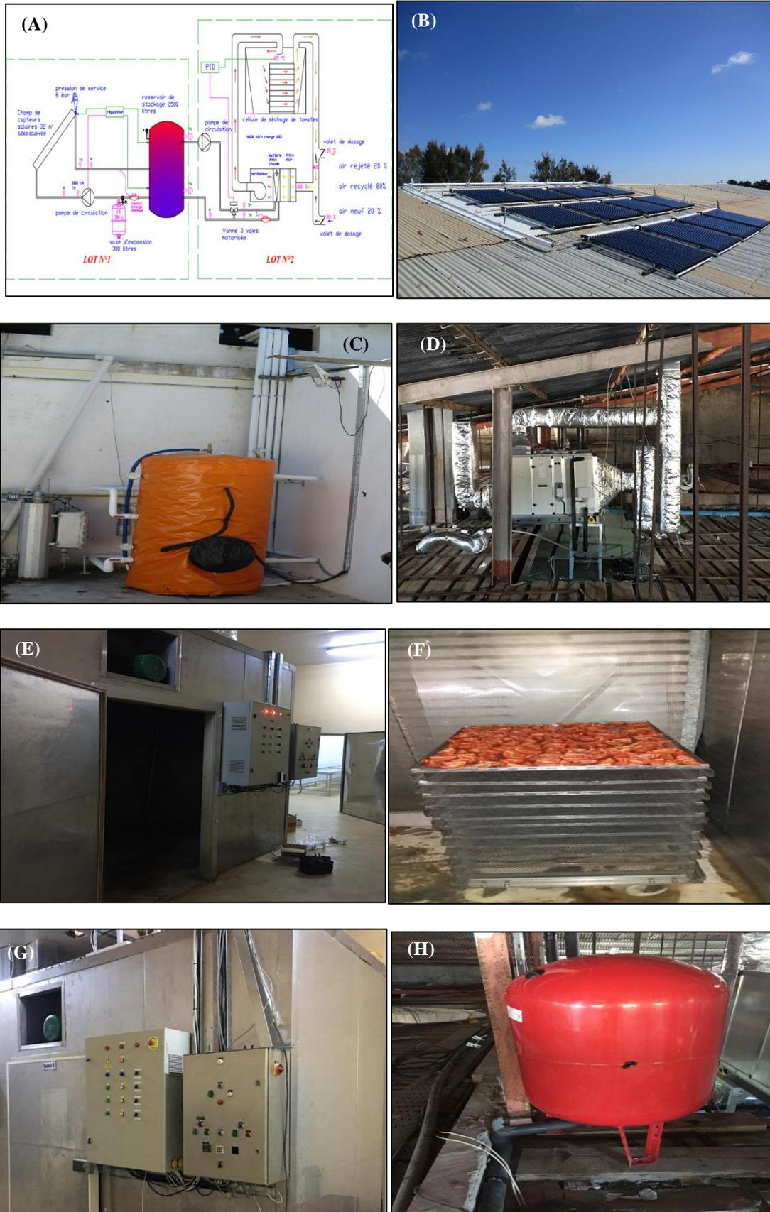
Figure -VII. 11- Le prototype du séchoir solaire pour les tomates (A) Schéma synoptique du prototype [86] (B) Le champ solaire (C) Le réservoir de stockage (D) L'unité de traitement de l'air (E) La chambre du traitement phytosanitaire (F) Chariot des tomates à l'intérieur
