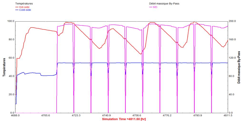
Figure -VI. 7- Température d'entrée et de sortie de l'échangeur de chaleur eau/air en été avec ensoleillement sans couverture du ciel
