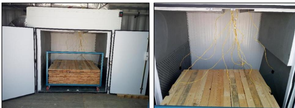
**Figure -IV. 10- Emplacement des thermocouples dans la chambre de traitement et la pile de bois**
